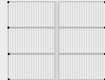
Pérgola compartiendo columnas con estructura de acero central
